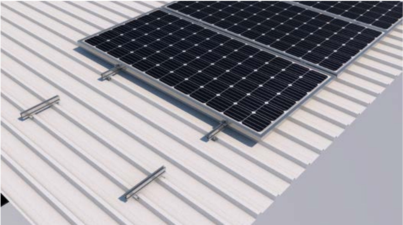
Disposición módulos vertical.
