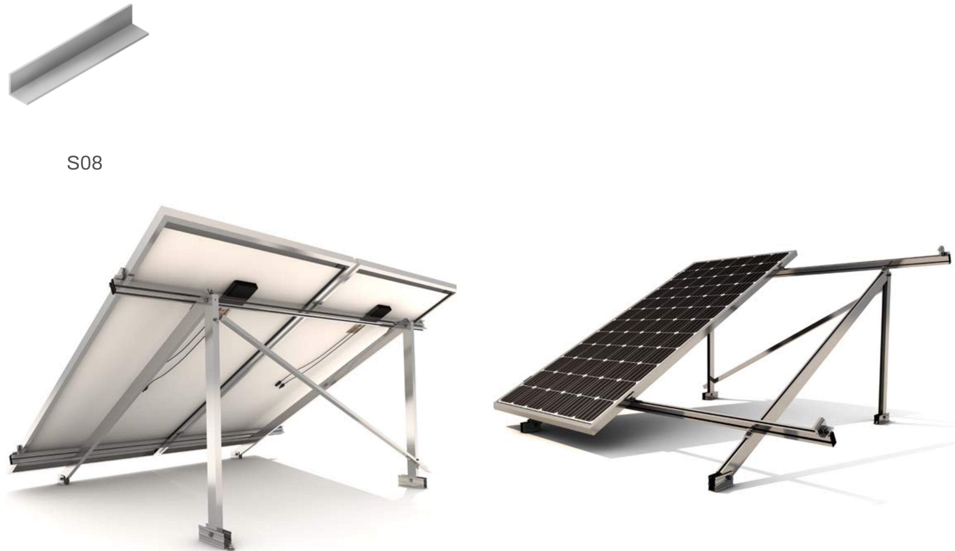
Instalación en cubierta de chapa. Todos los puntos de anclaje del triángulo deben siempre anclarse a la correa de la cubierta. En caso contrario se deberá colocar una subestructura. Consultar apartado de subestructuras de este catálogo.
